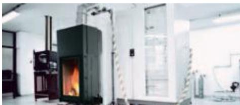
Analizzatore della combustione: i prodotti vengono testati in condizioni reali
