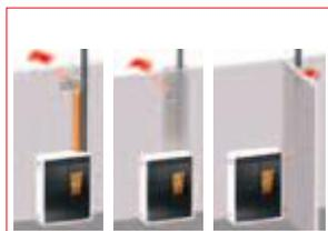
Alternative per uscite fumi e canalizzazione
